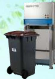
茨城県の電気通信設備会社にてプレモ750を設置しました。導入の目的は、工事後、不要になった梱包材・緩衝材にかかる処理費用の削減。比較的反発力の強く嵩張る軟質プラスチック廃棄物を、プレスキープ機能をフルに活用して、プレモ750で240Lのコンテナに圧縮。大幅な処分費用の削減と省スペースに貢献しております。
