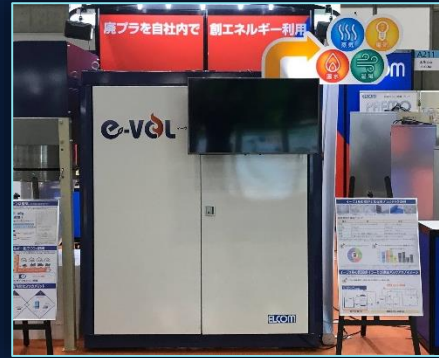
廃プラエネルギー化：樹脂パレットボイラーイーヴォル
