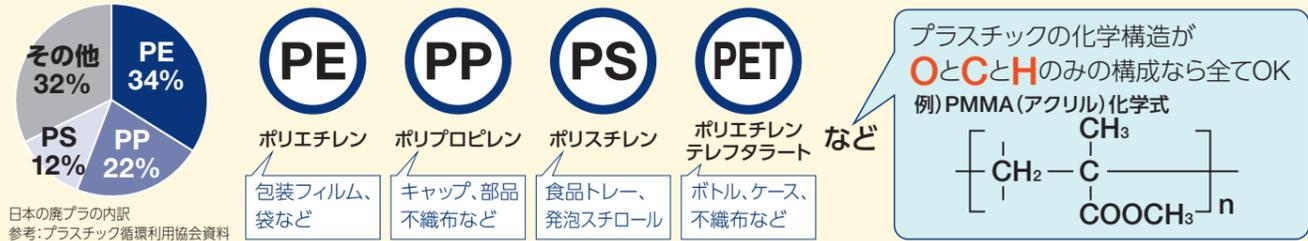
e-PEPシステムで燃料利用が可能なプラスチックの種類は、代表的なPE、PP、PS、PET樹脂などがあり、日本で廃棄されるプラスチックの約7割が対象となります。また、対象樹脂のみで構成される混合プラスチックや複合材、汚れのあるプラスチックも燃料化が可能です。
